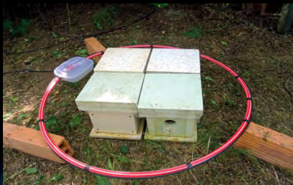
Obr. 2: Čtyři úlky, tzv. oplodňáčky, jsou umístěny ve středu antény, která generuje elektromagnetický radiofrekvenční šum.
