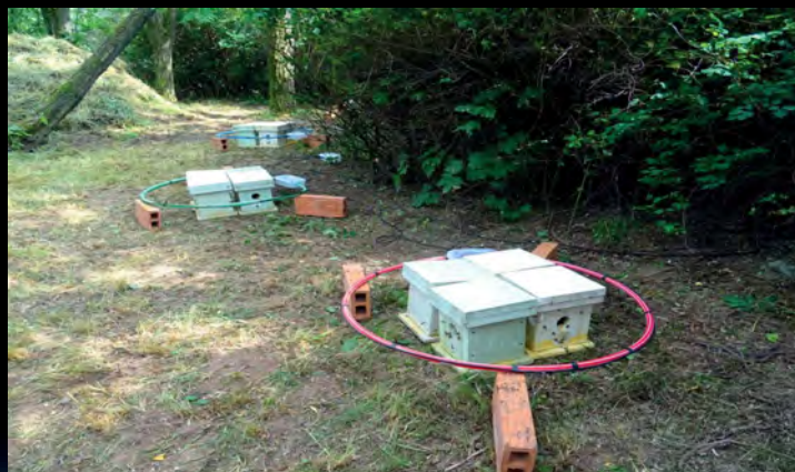
Obr. 3: Rozmístění antén generujících elektromagnetický šum zajišťuje, že sousední aparatury nejsou jakkoli vzájemně ovlivněny.
