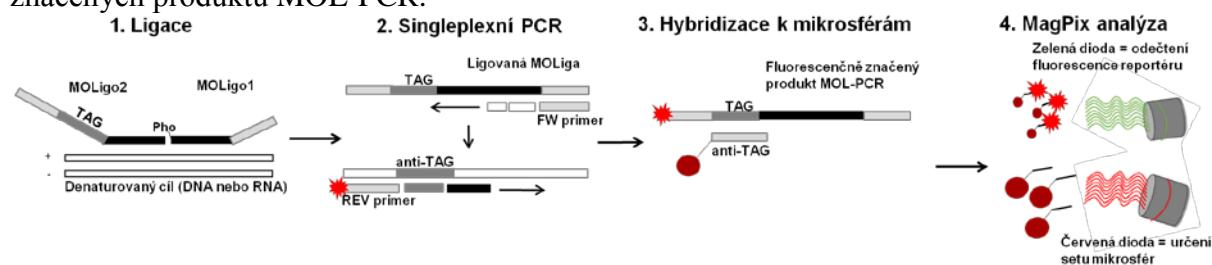
Obr. 1: Schéma průběhu MOL-PCR reakce a MAGPIX analýzy.
