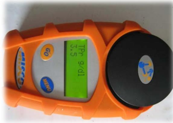
Velmi podstatnou vlastností pro výběr refraktometru je, zda vybraný typ má tzv. ATC – automatickou teplotní kompenzaci. S refraktometry pracujeme v prostředí s pokojovou teplotou.
