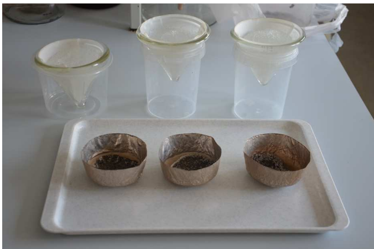
Obrázek 2: Žhání sorbentu v platinových miskách a filtrace vzorků
