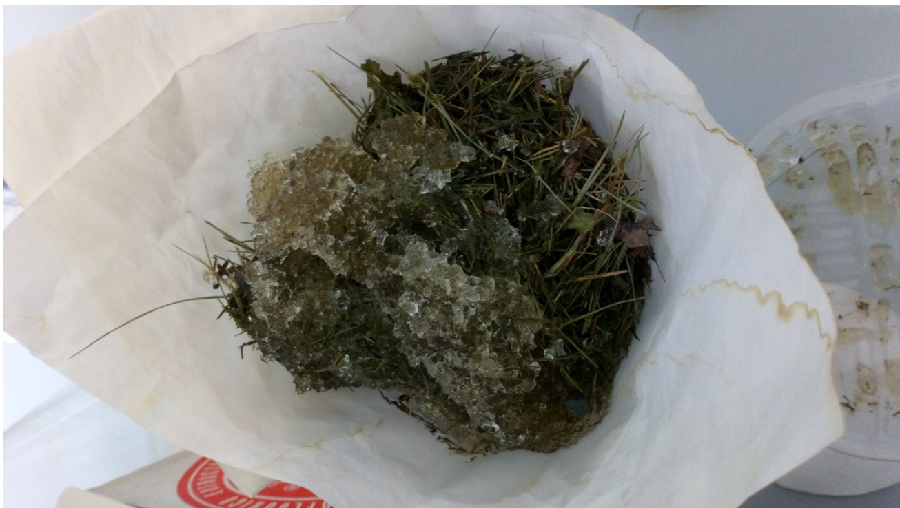
Obrázek 7: Viditelné nabobtnání sorbentu (varianta HySorb© Fem 33 N, 2g)
