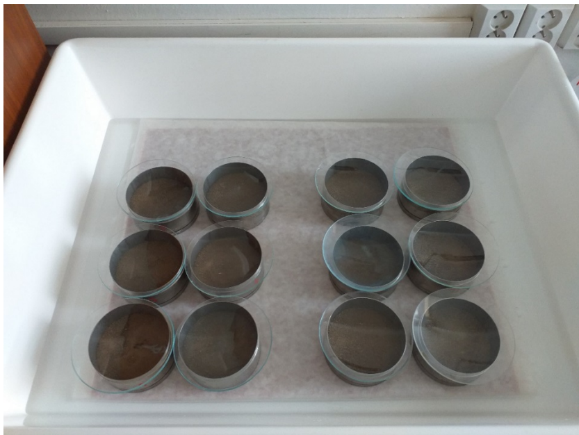
Obrázek 3: Sycení vzorků v testovacích válcích na filtračních papírech
