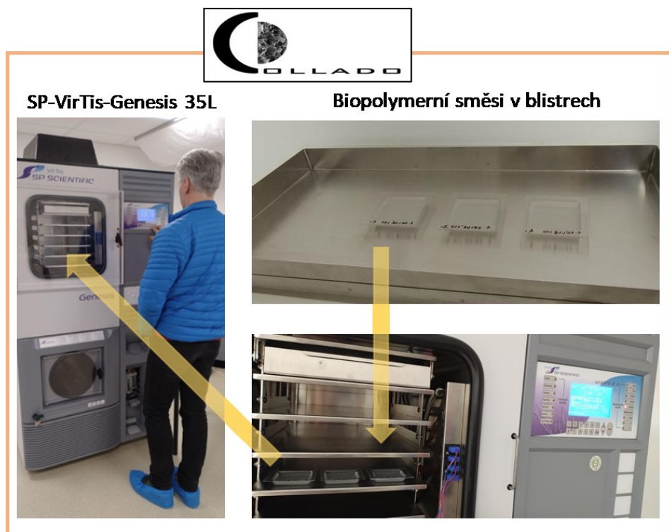
Obrázek 2. Výroba biopolymerní pěny obohacené enzybiotikem LYSSTAPH T2 na průmyslovém zařízení ve společnosti Collado s.r.o. v provozovně Hovorany.
