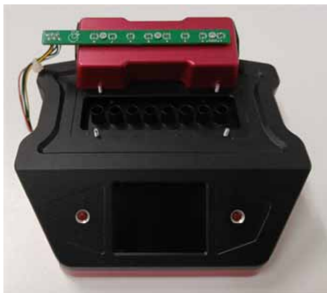
Obrázek 17: Pohled na osm jamek prototypu pro analýzu osmi vzorků současně.
