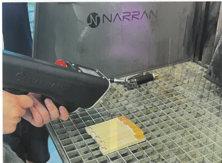
Obr. 3a Detail expozice pokusných ploch laserem
