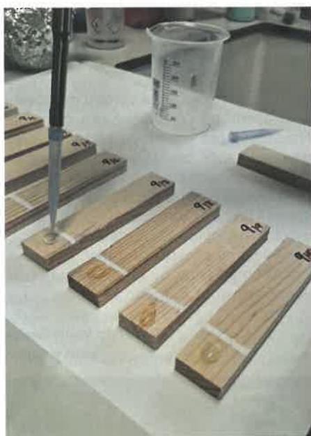
Obr. 2 Umělá infekce dřevěk v laboratoři Foto: V. Jeřábková
