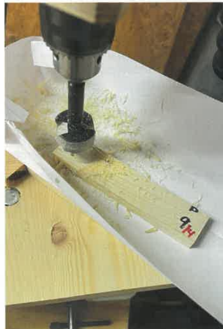
Obr. 4 Frézování povrchu pokusných dřevěk Foto: D. Titěra
